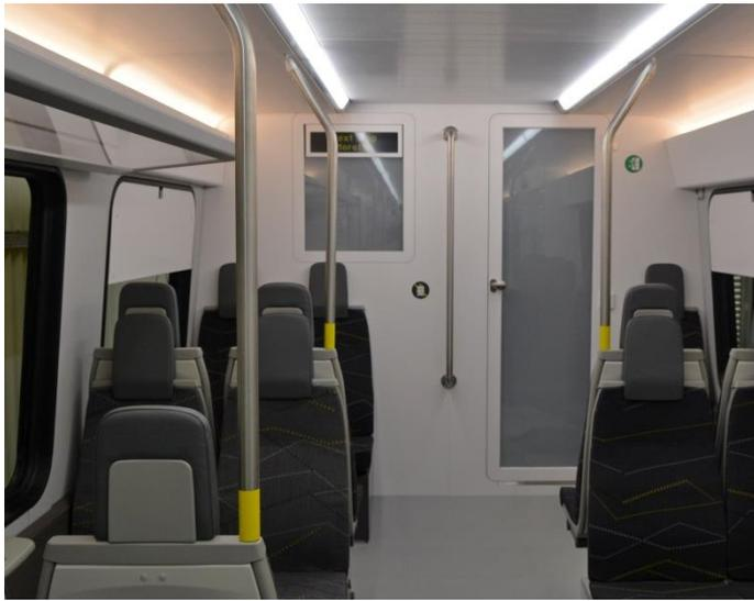
Fig. 4 Opaque / transparent glass cab door
